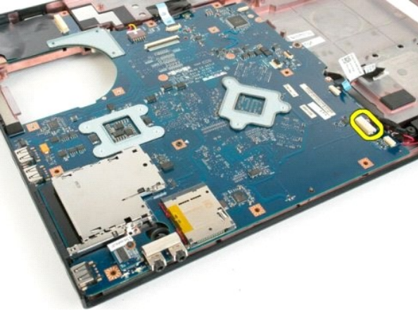
13. Lepas kabel modul Bluetooth® dari board sistem.
