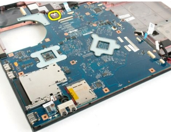
15. Lepas tiga sekrup yang mengunci board sistem ke sasis komputer.
